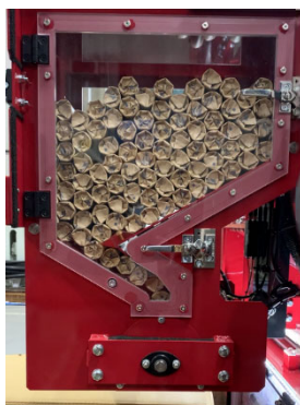
図-5：爆薬格納状況
