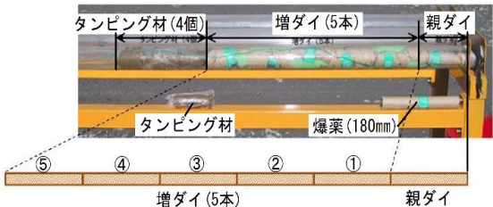
図-5 爆薬遠隔装填システムによる密装填状況（模擬実験）
