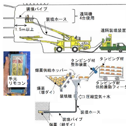
図-1 爆薬遠隔装填システムの概要
