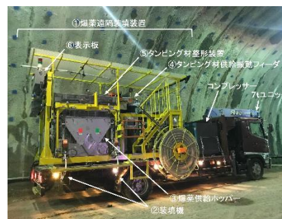
写真-3 爆薬遠隔装填装置
