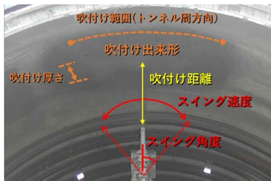
図-1 吹付け実験（模擬トンネル）
