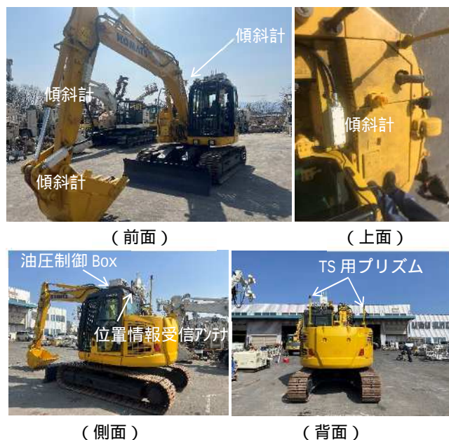
写真1 マシンコントロール化したPC138LS
