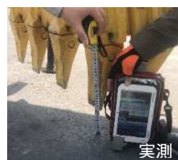
(測点 A-4 設計 145mm、実測 105mm、差 40mm)
