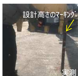
(測点 C-1 設計 718mm、実測 668mm、差 50mm)
