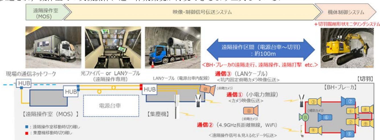
図－1 「Tunnel RemOS-Excavator」のシステム構成例
