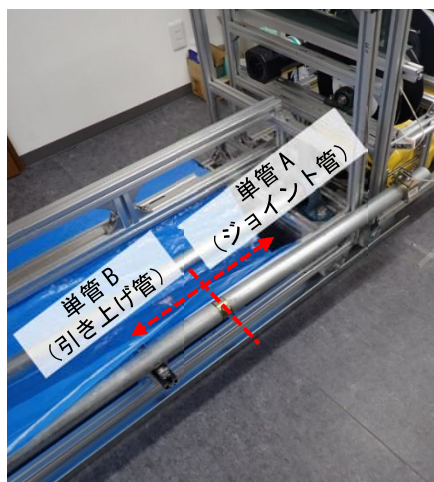
写真-2 法尻部単管接続状況
