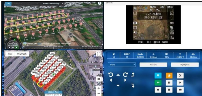
図-3 UAV 遠隔操作画面
