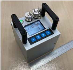
写真-3 小型密度計試作器
