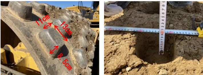
写真-1 タンピングローラの突起
