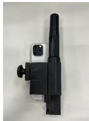
写真 2 外付け RTK レシーバ
