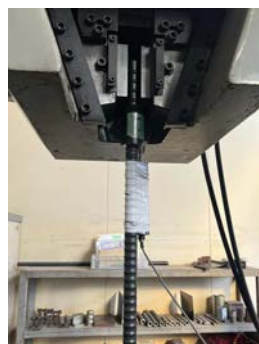
写真-4 継手引張試験
