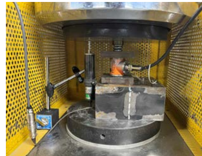
写真-3 ばね定数の測定試験
