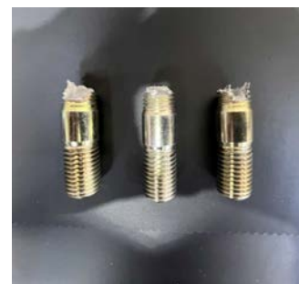
写真-5 ピンボルト破断状況
