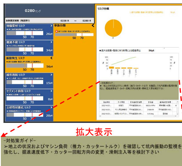
図-5 振動発生リスク警報時の画面（280 リング）
