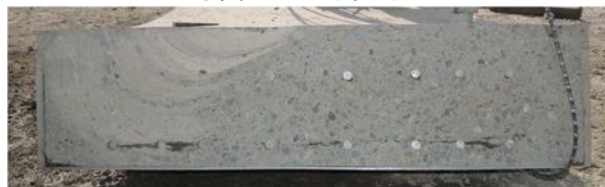
写真2 内部破壊状況
