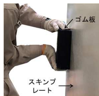
図-3 ゴム板の計測状況
