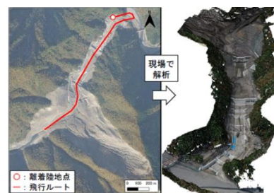
図-2 UAV レーザ計測の概要
