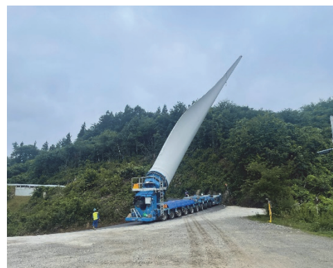
写真-1 風車部材の輸送状況
