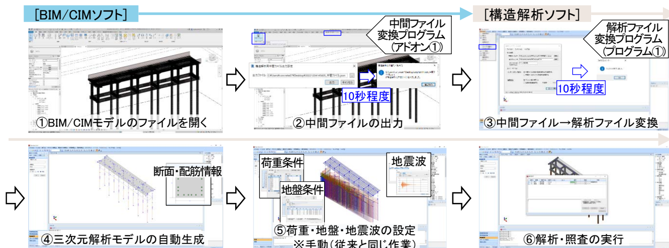
図2 BIM/CIMモデルから三次元骨組解析モデルの自動作成状況
