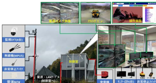
図-4 制御室の外観及び機器構成
