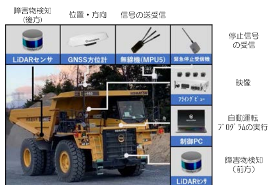
図-2 55t 級自動化ダンプトラック
