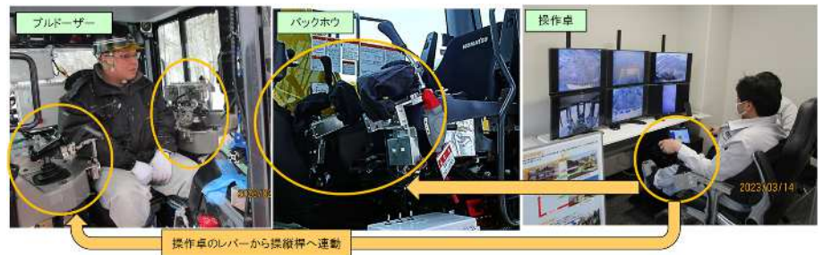
図-4 操作卓と除雪車の装置が連動するしくみ
