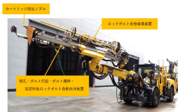
写真-1 セミオートロックボルト自動打設機
