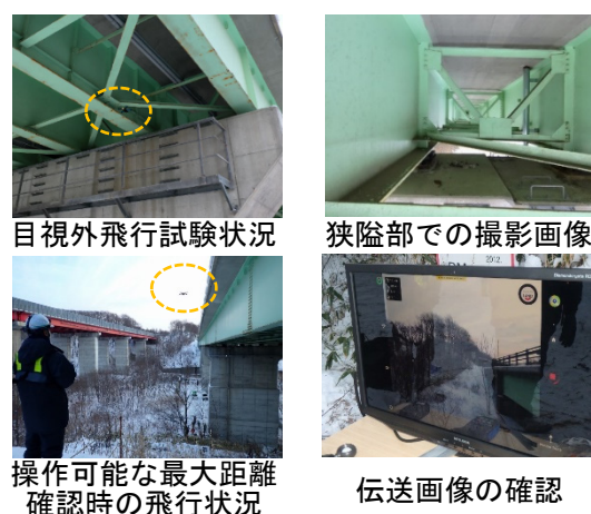
図-6 目視外飛行等の試験状況
