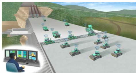
図-1 次世代の自動化施工システムの概念図
