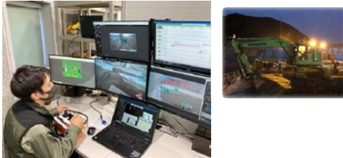
写真-2 遠隔操作および実機稼働状況
