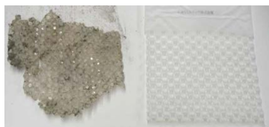
(a) 土中劣化 (b) 気中劣化
