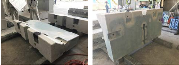
写真-1 低炭素型コンクリートの仮設防護柵
