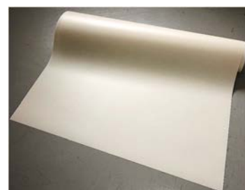
写真1 吸水性樹脂含有型枠用シート
