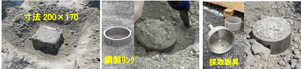
写真-1 試料の採取状況（左: ブロック, 中: 鋼製リング, 右: コアカッター法）
