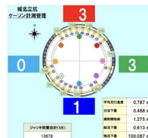
写真-5 躯体姿勢監視モニター
