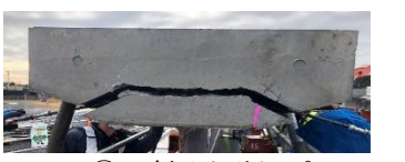
(d) No.⑧ 斜め切断 30° ジベル筋ピッチ 150mm
