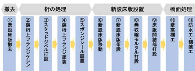
図-4 床版取替工の作業手順
