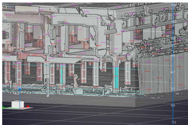
図-2 3D レーザースキャナによる点群モデル
