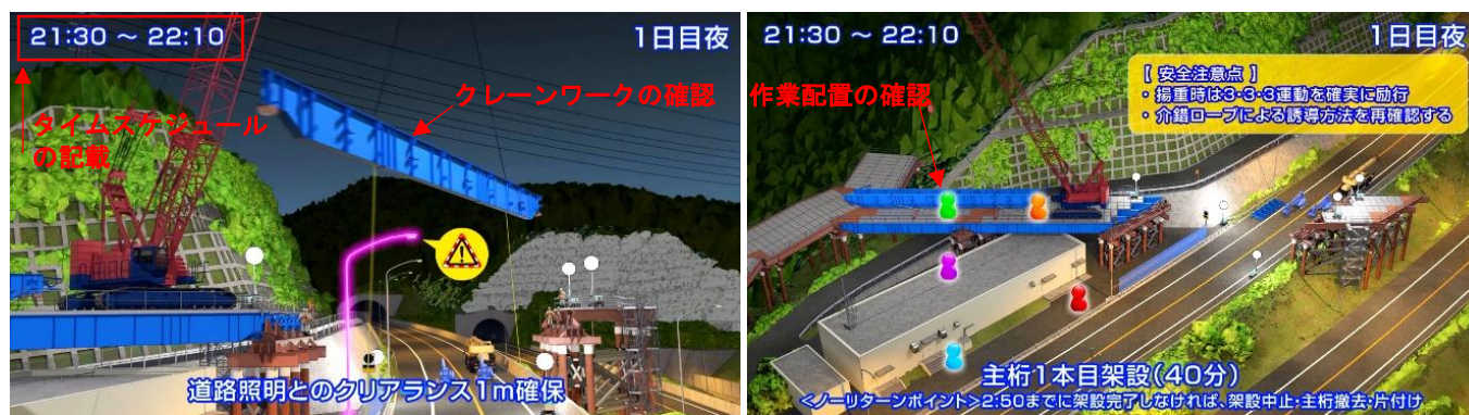
図-4 三次元施工シミュレーションの様子
