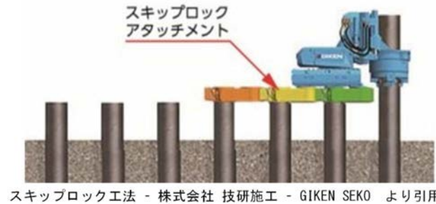
図 3. 2 スキップロック工法 2)
