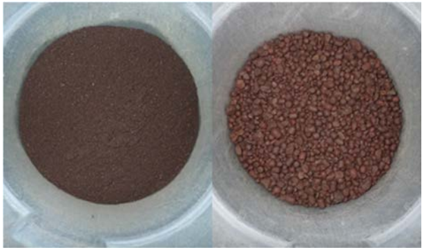
写真-2 軽量骨材（左：細骨材、右：粗骨材）
