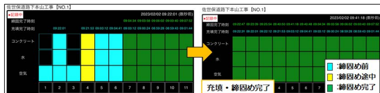
図 2 充填・締固め管理確認状況(タブレット画面)
