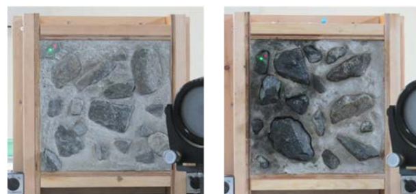
写真-1 健全骨材供試体 写真-2 浮骨材供試体
