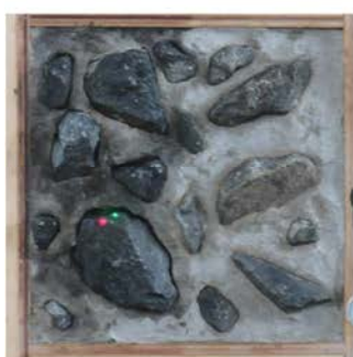
写真-4 浮き骨材供試体の計測骨材
