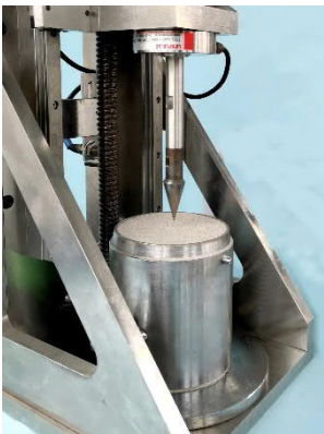
写真-4 コーンを 取り付けた状態
