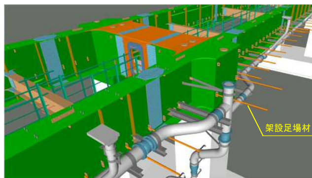
図-1 付属物、足場材を含む詳細な3次元モデル
