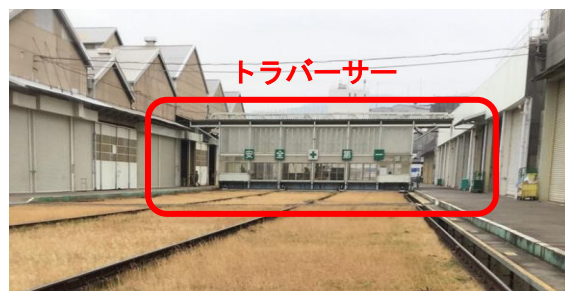
図-1 トラバーサー(近畿車輛工場内)
