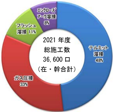
図 1 溶接法と実績 (JR)
