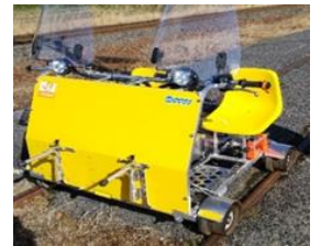
写真-1 ガソリン式点検カート
