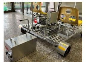
写真-3 バッテリー脱装状況
