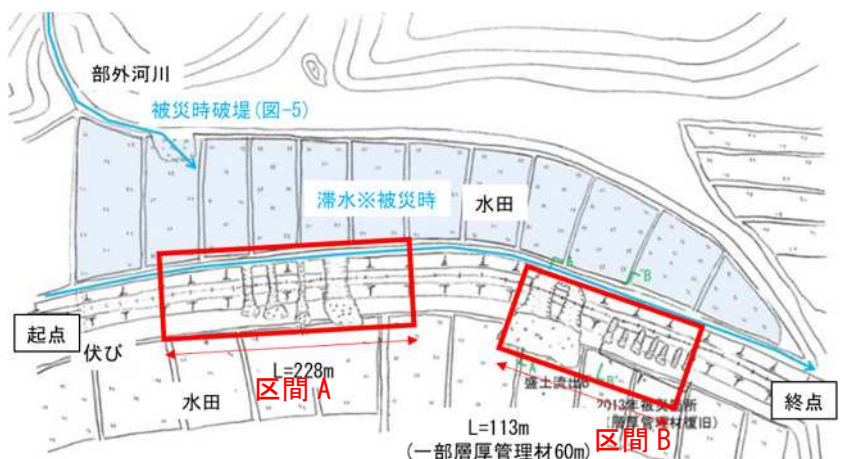
図-2 盛土流出箇所
