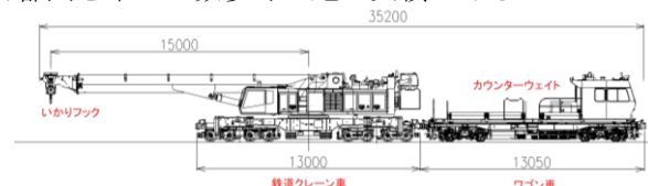
図-2 鉄道クレーン車側面図
