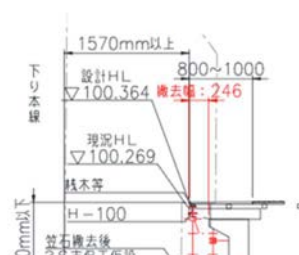
図-④ 下り本線ホーム撤去断面図
