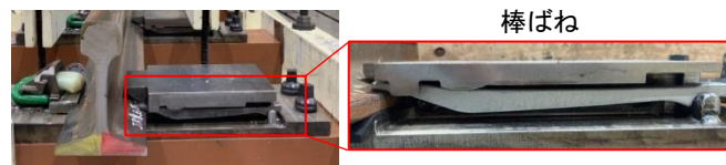
図 2 棒ばね仕様の締結構造
