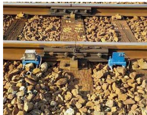
図-3 遊間測定装置による24時間測定
