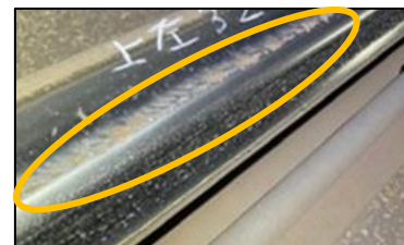
図-3 HH340 のキシミ傷の発生状況
