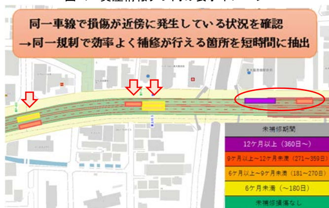
図-5 効率的に補修箇所を抽出する使用イメージと未補修残置期間別の凡例イメージ
