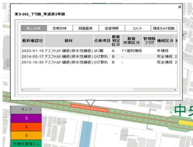
図-3 舗装損傷の色表示による見える化と車線情報ウィンドウの立ち上がりイメージ
