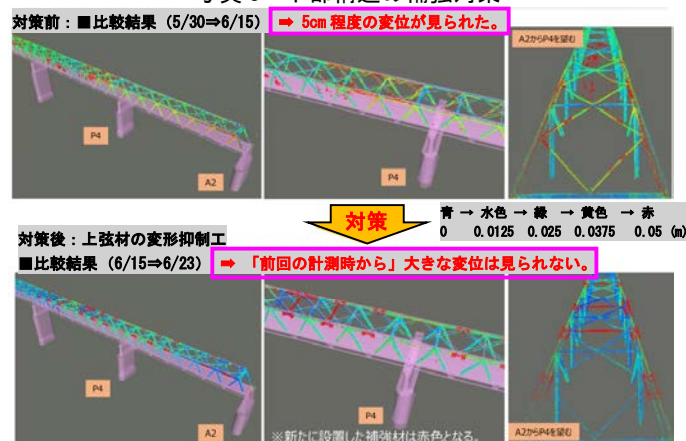
図2 3次元地上レーザー計測(LP)による変状確認
