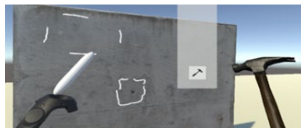
図-1 VR 試験体 打音点検精度測定試験の様子
