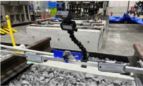
図-2 建築限界測定器フレーム (カメラ設置状況)
